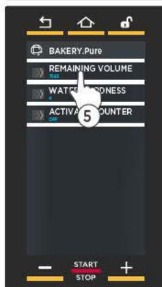
Sélectionnez le paramètre «volume restant» : sur l'écran apparaîtront les litres résiduels qui manquent avant de devoir remplacer le filtre.
