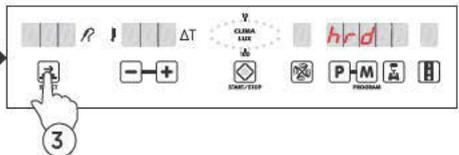
Die Tasten drücken, bis auf dem Display "hrd" angezeigt wird.
