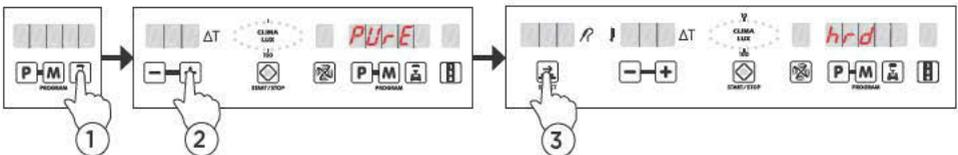
Die Tasten drücken, bis auf dem Display "PURE" angezeigt wird.
